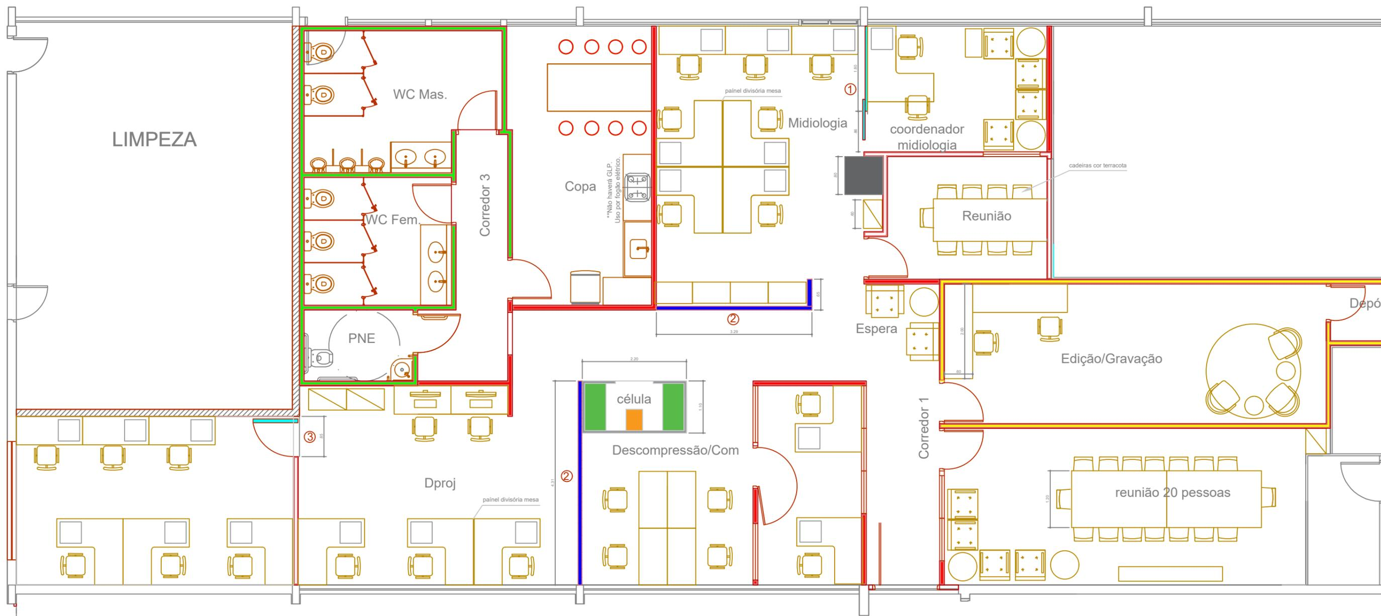
① Divisória piso teto com testeira em madeira recortada para encaixe dos eletrodutos. Em vidro adesivado. Porta de correr.
